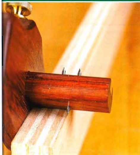
Установите шпильки по размерам детали...
