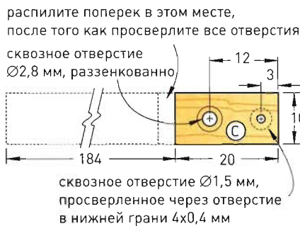
РИС. 2. НЕПОДВИЖНЫЙ ФИКСАТОР РАЗМЕТОЧНОЙ ШПИЛКИ (ВИД С ВЕРХУ)
