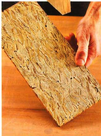
Распилите Parallam поперек для выявления ни на что не похожей в деревообработке текстуры. Пустоты, которые вы видите здесь, необходимо заполнить.
