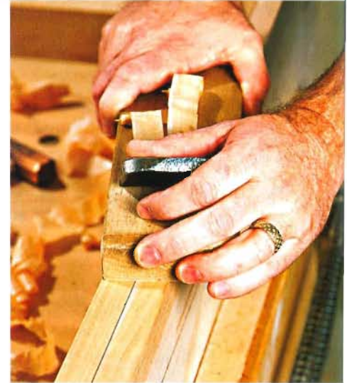
Делайте рубанком проходы по всей длине кромки. Ровно удерживайте инструмент, прижимая его подошву к обрабатываемому материалу. Строгайте до тех пор, пока из летка рубанка не станут выходить две непрерывные стружки.
