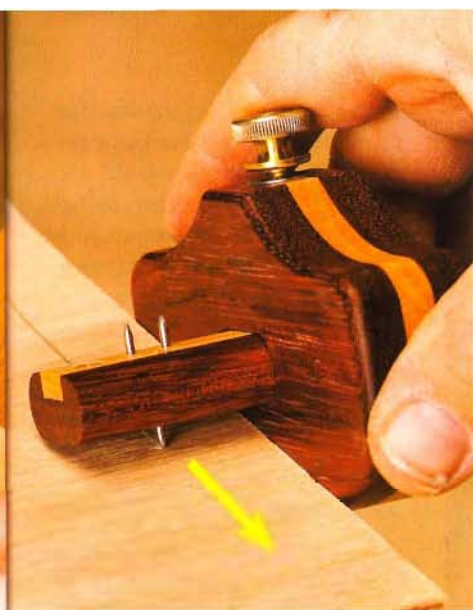
... или надрезания фанеры для предотвращения сколов при выборке фальца.
