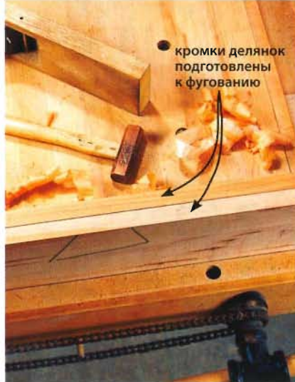
Выровняйте смежные кромки досок. Большие верстачные тиски обеспечивают надежный зажим деталей, но струбцины справятся с этой задачей не хуже.
