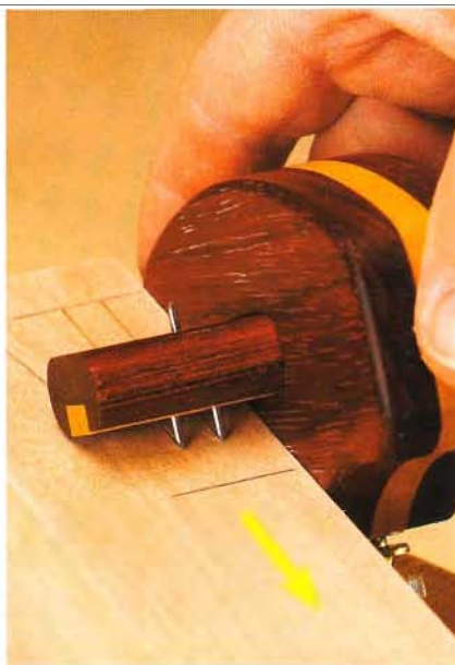
Установите парные шпильки по ширине шипа и начертите контуры паза на заготовке.
