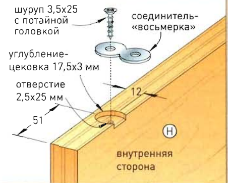
РИС. 3В. УСТАНОВКА СОЕДИНИТЕЛЕЙ «ВОСЬМЕРОК»
